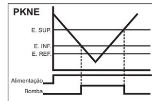
**PKN:** Próprio para poço artesiano, protegendo a bomba em caso de falta de líquido no reservatório. Funcionamento: quando o líquido condutivo cobrir os eletrodos de referência e inferior, e depois o eletrodo superior, o contato de saída comuta para a posição de trabalho, ficando neste estado até o líquido descobrir o eletrodo inferior, quando o contato de saída volta para a posição de repouso.
