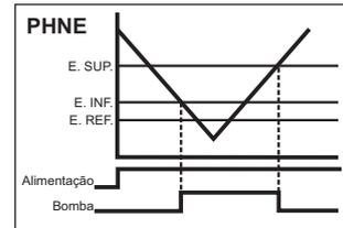
**PHN:** Próprio para poço artesiano, protegendo a bomba em caso de falta de líquido no reservatório. Funcionamento: quando o líquido condutivo cobrir os eletrodos de referência e inferior, e depois o eletrodo superior, o contato de saída comuta para a posição de trabalho, ficando neste estado até o líquido descobrir o eletrodo inferior, quando o contato de saída volta para a posição de repouso.
